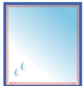
Reduzierter Wärmeverlust durch die warme Randzone.
